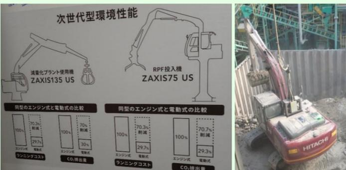
次世代型環境性能：電気で稼働する重機
