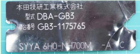
図3. コーションプレートの例
