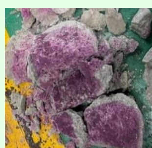
EB単体の強度試験後 (灰色が中性化部分)
