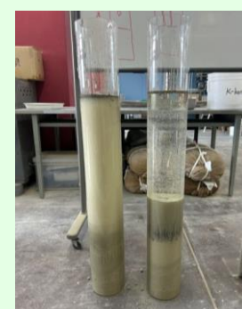
杭の埋め戻し 模型実験
