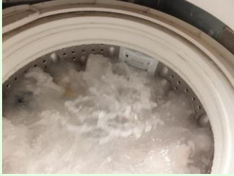
洗濯機6分攪拌後80%位剥離
