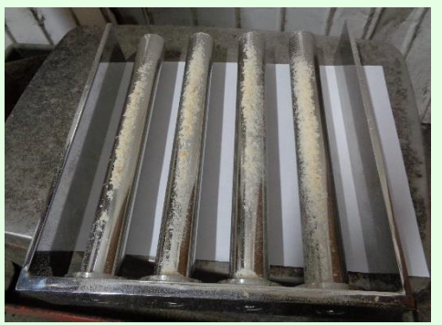
磁選機に付着した粉 ・現在、これらの粉の中の鉄成分の濃度を分析予定で準備中。
