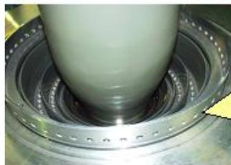
写真2 インフレーション成形工程
