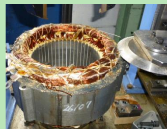
ステーターの切断分離を試みているがさらなる改良が必要
