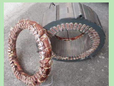
ステーターの切断分離を試みているがさらなる改良が必要
